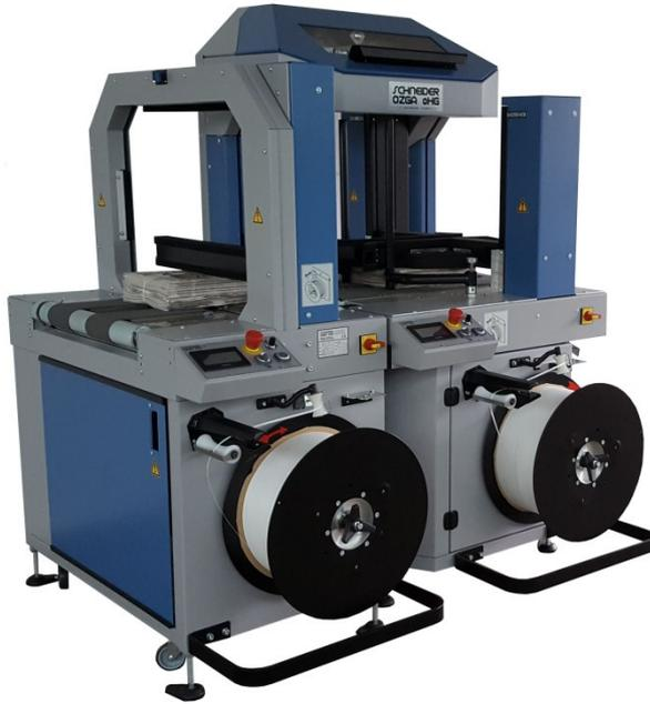
Bei der Längsumreifungsanlage muss das Packgut nicht gedreht werden, um eine Kreuzumreifung zu erhalten. Instabile Produkte durch viele Beilagen oder Hochglanz Produkte werden hier sicher verarbeitet. Durch den Wegfall der Drehkreuzwende ist die Anlage sehr platzsparend.
